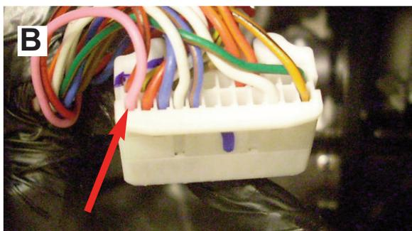
**N.B:** Interporre tra il filo **AZZURRO/VERDE** e il filo **ROSSO** del cablaggio allarme la resistenza da **4K7 Ohm 1/4 w**
